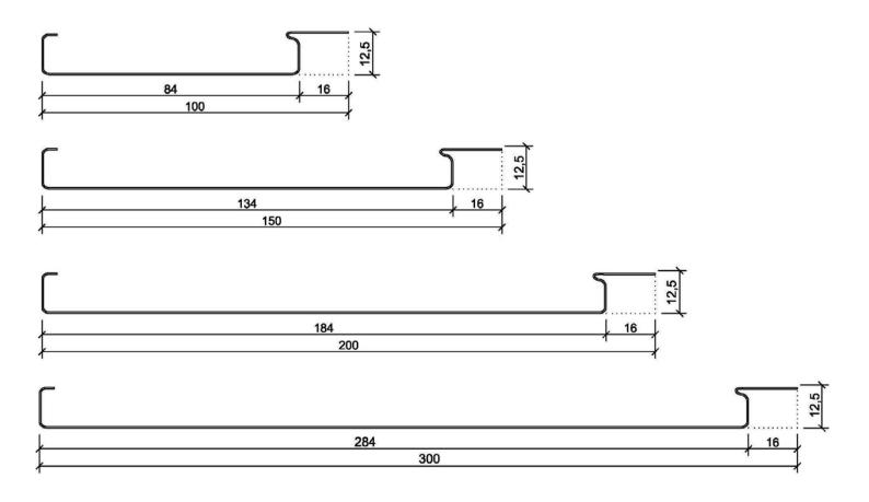
Die Modulbreite entspricht Paneelbreite + 16mm Fuge.
