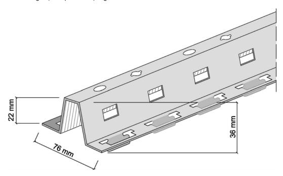
Die Universaltrageschiene gibt es als Sonderausführung auch in flacher Ausführung (Darstellung unten links) für eine Direktmontage an die Rohdecke. Da können zum Beispiel Rundungen wie auf dem rechten unteren Bild ausgeführt werden. Diese Art der Montage kann zum Beispiel in älteren Kellergewölben Anwendung finden.
