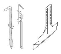
Wir können fast jede Art von Abhänger für ihre Deckensysteme liefern, ob Nonius (für Klemmsystem, Holzkonstruktion, Bandraster, T-Schiene u.s.w.), Abhangdrähte (b.z.w. Schnellspannhänger) oder Bandeisen als Rollenware mit den zugehörigen Unterteilen.
