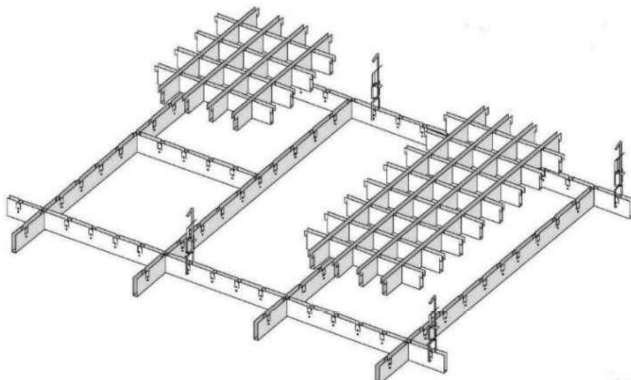
Die werkseitig mitgelieferte Unterkonstruktion (Trageschienen) sind in Farbe und Stegbreite identisch mit den gelieferten Rasterelementen. Die Trageschienen werden mit speziellen Noniushänger abgehängt.
