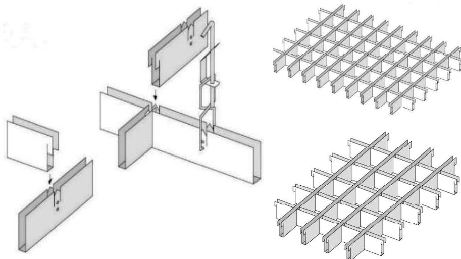
Nach Montage der Unterkonstruktion erfolgt die Montage der Rasterelemente (Standardgrößen: 600x600mm und 1200x600mm). Die unterschiedlichen Raster-Stegbreiten kombiniert mit unterschiedlichen Wabengrößen erlauben eine große Auswahl an Variationen.
