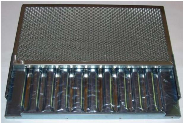
Unsere hochmodernen Kombifilter bestehend aus zwei miteinander verbundenen Edelstahl-Flammenschutzfilter und Edelstahl-Fettfangfilter leiten den Dunst im Inneren des Filters in einen kräftigen Wirbelstrom. Dieser schleudert das Fett an die Fettwände, von dort läuft es in den Fettkanal der Abzugshaube, wo es bis zur Leerung sicher und sauber aufbewahrt wird.
