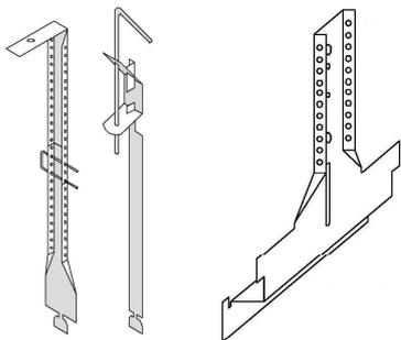
Wir können fast jede Art von Abhängen für ihre Deckensysteme liefern, ob Nonius (für Klemmsystem, Holzkonstruktion, Bandraaster, T-Schiene u.s.w.), Abhangdrähte (b.z.w. Schnellspannhänger) oder Bandeisen als Rollenware mit den zugehörigen Unterteilen.
